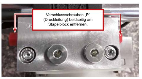
7.6.2 Hydraulikschläuche mit Druckleitung "P" (G3/8" Innengewinde) am Stapelblock verschrauben.
