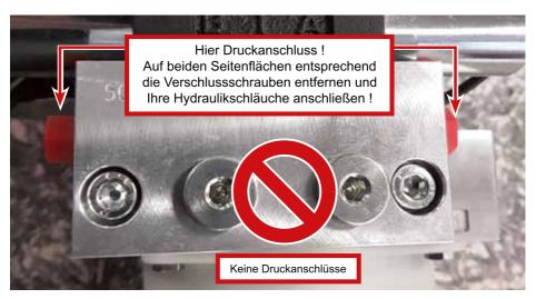
**7.6.3** Aggregat mit Hydrauliköl befüllen (Siehe hierzu Seite 6,9 und 10)
